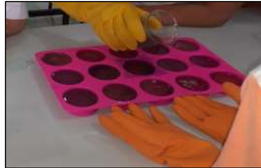
Gambar 2. Proses Pencetakan Sabun Ultra Transparan berbasis VCO
