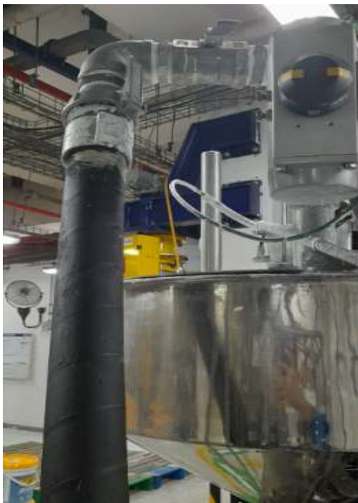
Gambar 7. Hopper dan selang mesin Automatic filling no 3 ( single line untuk semua base)
