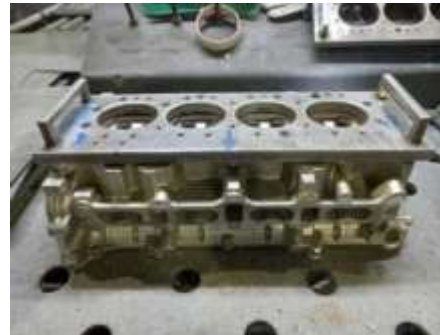
Gambar 6 Proses Pengecekan Produk Cylinder Head Menggunakan Jig Khusus Setelah Improvement
