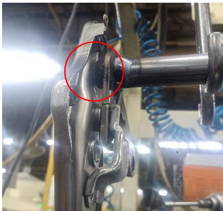
**Gambar 3.** Part NG Bolong pada titik pengelasan
