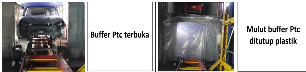
**Gambar 8** Kondisi sebelum dan sesudah instalasi penutup buffer
