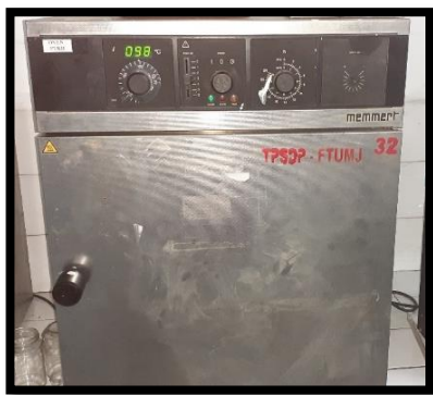
Gambar 2. Oven yang digunakan dalam penentuan kadar air nata de coco
