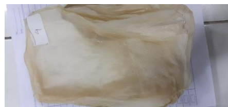
Gambar 6. Contoh Gambar Pengeringan selama 4 jam tetapi bagian sisi terlalu kering dan mudah rusak.
