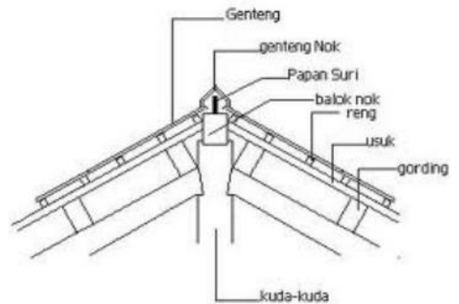
Gambar 1. Konstruksi Rangka Atap Kayu
