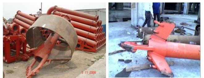
Gambar 16. Type Auger RCD
