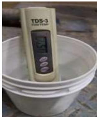
Gambar 14 Pengukuran TDS pada air baku
