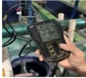
Gambar 11 Pengukuran konduktivitas pada air RO awal
