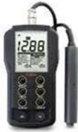
Gambar 7 Alat ukur konduktivitas
