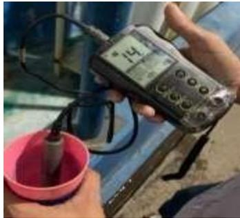
Gambar 12 Pengukuran konduktivitas pada air demin
