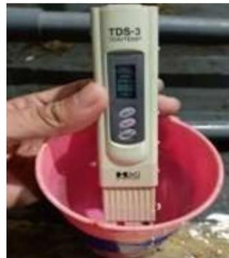
Gambar 15 Pengukuran TDS pada air demin
