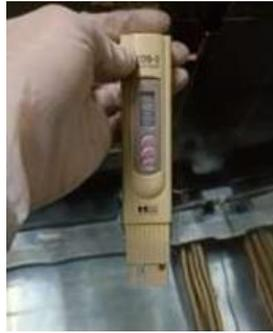
Gambar 16 Pengukuran TDS pada air RO akhir
