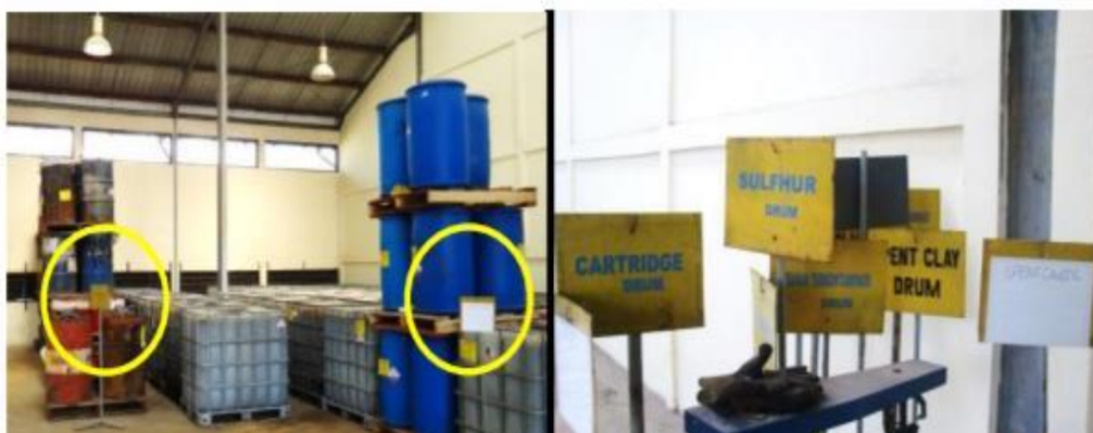
Gambar 12 Papan Petunjuk identitas limbah PT. Guna Era Manufaktur. Sumber: Dokumen & Data PT. Guna Era Manufaktur
