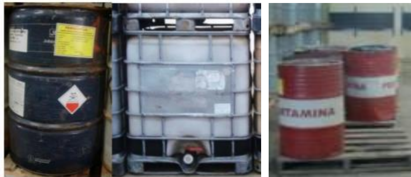
Gambar 3 Wadah penyimpanan limbah B3 sesuai dengan karakteristik limbah di PT. Guna Era Manufaktur Sumber: Dokumen & Data PT. Guna Era Manufaktur
