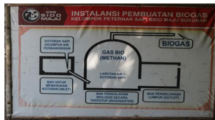
Gambar 4 Instalasi Pembuatan Biogas
