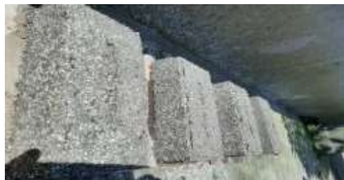
Gambar 4 Hasil Batako Jadi yang Dijemur Dibawah Sinar Matahari Sumber: Dokumentasi Penulis, 2022
