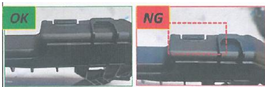
Gambar 4 Hinge crack pada part (Sumber : PT Schlemmer Automotive Indonesia, 2021)
