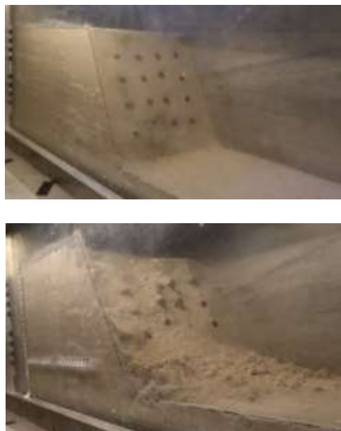
Gambar 7. Uji spesimen C-16 (A) Sebelum uji centrifuge (B) Setelah uji centrifuge dan runtuh pada 75 g
