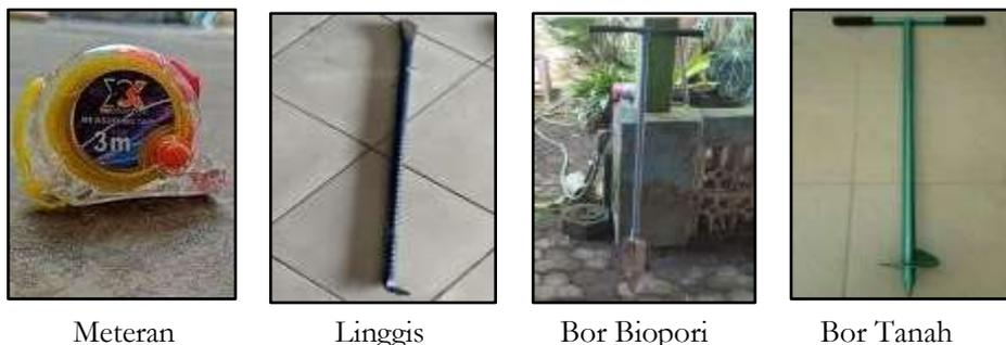
Gambar 3 Meteran, Linggis, Bor Biopori dan Bor Tanah
