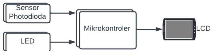
Gambar 5 Skema Rangkaian Sensor Photodiode
