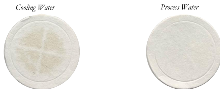
Gambar 4. Perbandingan Hasil Uji Air Pelarut Cooling Water (kiri) dan Process Water (kanan)
