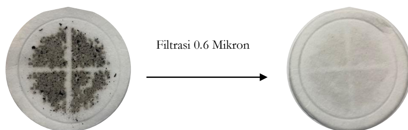
Gambar 5. Hasil Uji Produk Remelting PAC 18 dengan Filtrasi 0.6 Mikron
