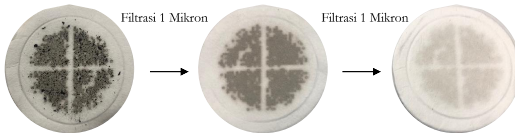
Gambar 6. Hasil Uji Produk dengan Filtrasi 1 Mikron
