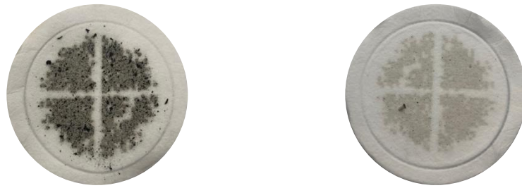
Gambar 3. Hasil Uji Produk Remelting PAC 18 (kiri) dan PAC 26 (kanan)
