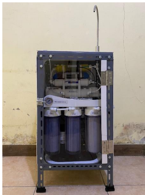
Gambar 2. Alat Pemurni Air / Reverse Osmosis (RO)
