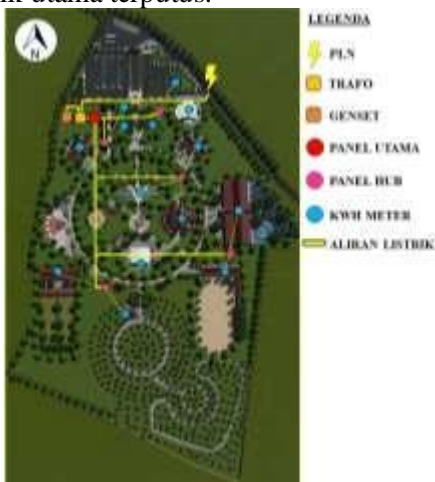
Gambar 27. Titik Distribusi Jaringan Listrik
