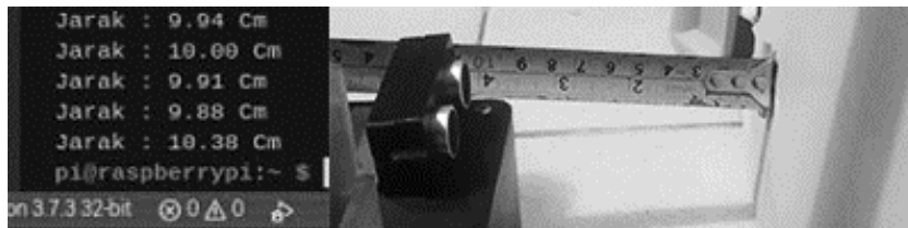
Gambar 14. Pengujian Sensor Ultrasonik Jarak 10cm
