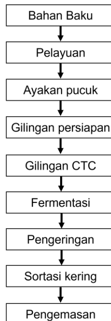
Gambar.1 Diagram Proses Pengolahan Teh Hitam secara CTC Sumber: Arifin, 1994
