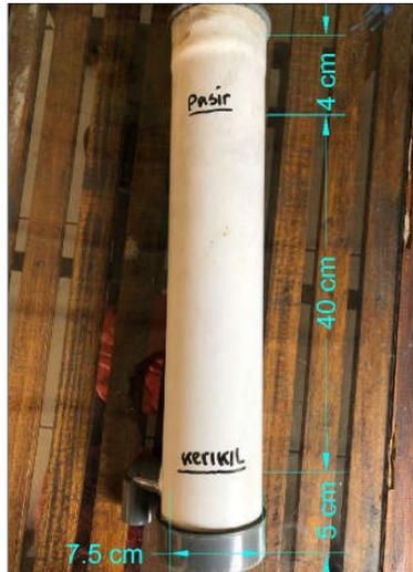
**Gambar 3.** Reaktor Filter
