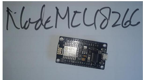
Gambar 5 NodeMCU ESP8266
