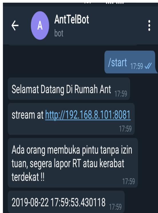
**Gambar 4. Hasil Pengujian Switch Pintu Magneti**
